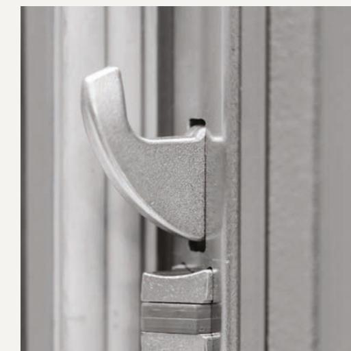
In acciaio zincato a forma di uncino, azionati dalla serratura, si agganciano completamente al riscontro verticale lungo formando così un corpo unico tra anta e telaio.
